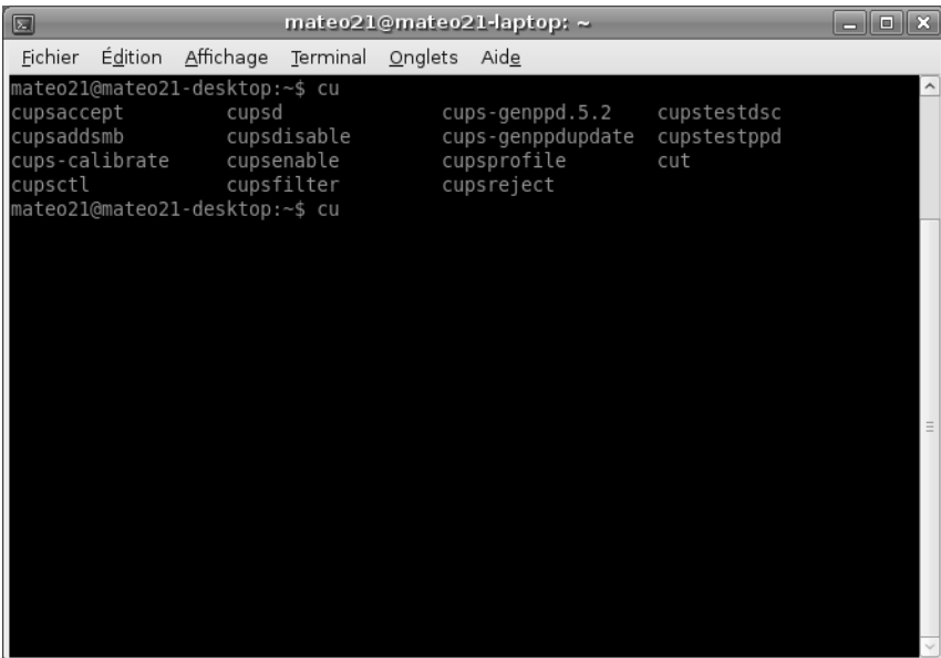
FIGURE 28.3 – Le shell autocomplète les commandes et les noms de fichiers
