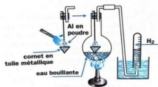
Fig. 5 : Réduction de la vapeur d'eau par l'aluminium
