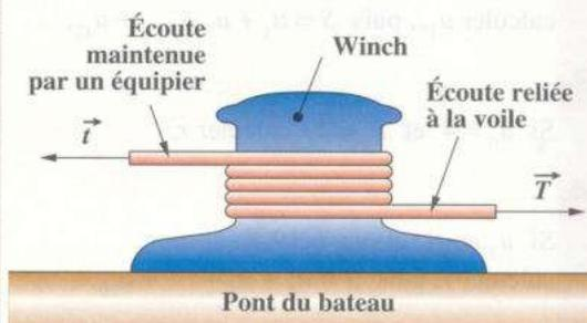
Si  $T$  est la norme de la tension exercée vers la voile et  $t$  la norme de la tension maintenue par l'équipier, on a la relation :  $\frac{T}{t} = e^{f\alpha}$ , où  $f$  est le
