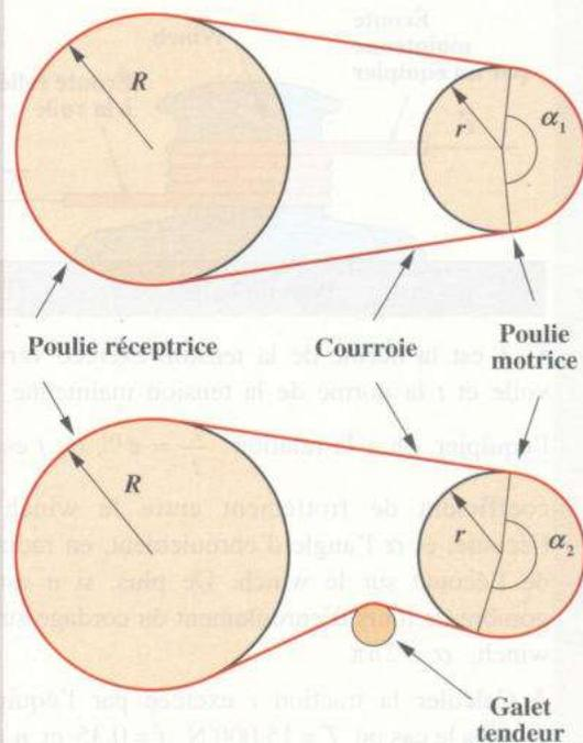
2. Le schéma ci-dessus montre qu'en faisant varier la longueur de la courroie et en utilisant un galet tendeur de courroie, on fait varier  $\alpha$ .
