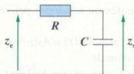
On associe respectivement à la tension d'entrée et à la tension de sortie les nombres complexes  $z_e$  et  $z_s$ .
