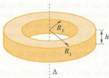
On appelle  $I_{1\Delta}$  et  $I_{2\Delta}$  les moments d'inertie respectifs des disques pleins, constitués du même matériau de masse volumique  $\rho$ , de rayons respectifs  $R_1$  et  $R_2$  et de hauteur  $h$ . On admet que  $I_{\Delta} = I_{2\Delta} - I_{1\Delta}$ .
