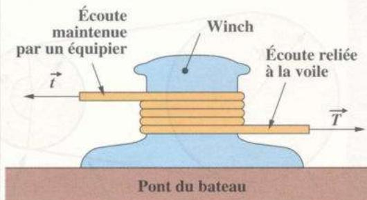
Si  $T$  est la norme de la tension exercée vers la voile et  $t$  la norme de la tension maintenue par l'équipier, on a la relation  $\frac{T}{t} = e^{f\alpha}$ , où  $f$  est le coefficient de frottement entre le winch et l'écoute, et  $\alpha$  l'angle d'enroulement, en radians, de l'écoute sur le winch. De plus, si  $n$  est le nombre de tours d'enroulement du cordage sur le winch,  $\alpha = 2n\pi$ .
