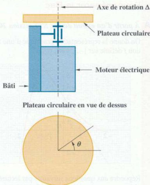
Pendant la phase de démarrage, la loi du mouvement est donnée par  $\theta(t) = 12,5\pi t^2$ , où  $\theta$  est l'angle de rotation du plateau en radians et  $t$  le temps en secondes.
