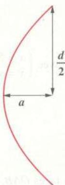
En faisant tourner une parabole autour de son axe focal, on engendre une surface nommée paraboléoïde de révolution. C'est le cas, par exemple, pour une antenne dite parabolique.
