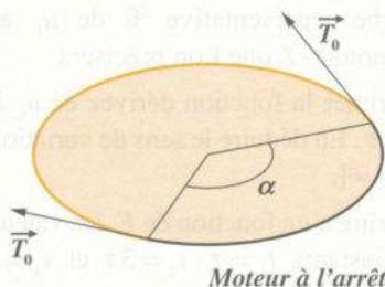
Pendant le fonctionnement du moteur, les tensions dans les deux brins ne sont pas identiques. Conformément au schéma ci-après, le brin opposé au sens de rotation supporte une tension dont la norme  $T$  est supérieure à la norme  $t$  de la tension que supporte l'autre brin.
