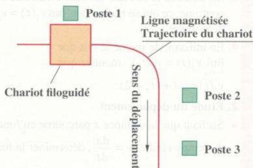
Pour obtenir un effort de traction progressif lors du démarrage, on adopte une accélération  $a$  dont la loi de variation au cours du temps est sinusoidale et admet une expression sur  $\left[0, \frac{4}{3}\right]$  de la forme  $a(t) = -0,45(\cos(\omega t) - 1)$ , où  $\omega \in ]0, 2\pi]$ .
