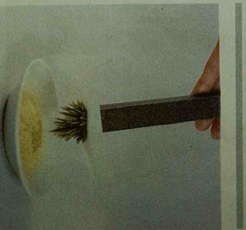
FIG. 14. Triage magnétique du mélange fer-soufre. Un papier filtre empêche la limaille de fer de s'incruster dans l'aimant.
