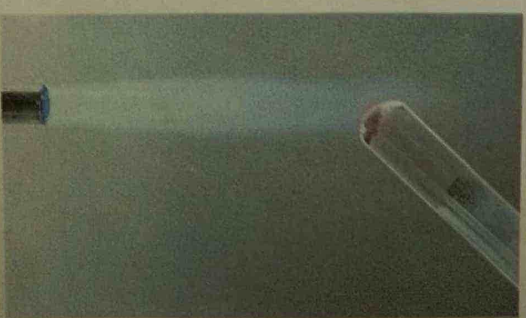
FIG. 4. Analyse de l'oxyde de mercure. Des gouttelettes de mercure se déposent sur la paroi froide du tube.
