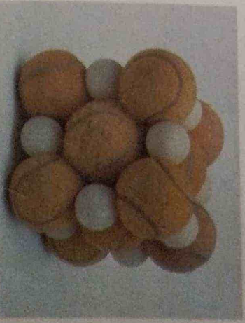
FIG. 2. Modèles de la structure cubique du chlorure de sodium. a. Modèle éclaté : les boules rouges représentent les ions \text{Na}^+ , les boules bleues les ions \text{Cl}^- .
