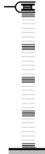
Figure 2b : Le ressort vibre en présentant des parties floues et des parties nettes, alternées.
