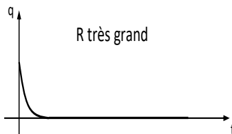
Courbes q = f(t) en fonction de la valeur de la résistance du circuit
