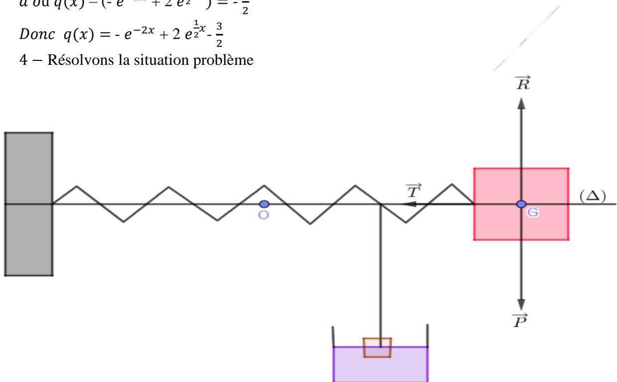
*oscillateur mécanique amorti*
