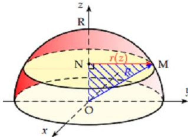
La figure ci-dessus représente une demi-sphère de rayon  $R$  représentée dans un repère de l'espace  $(O, O_x, O_y, O_z)$ ,  $M(x, y, z)$  est un point quelconque appartenant à cette demi-sphère. On sectionne cette demi-sphère avec des plans parallèles au plan  $(xOy)$  et passant par  $M$ , et on obtient le disque de centre  $N(0,0, z)$  et de rayon  $r(z)$ .
