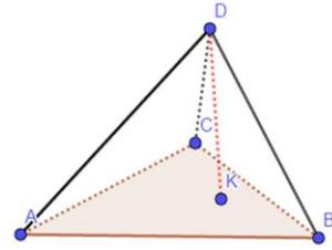
Pour le réservoir tétraédrique, on aura  $\mathcal{V}_{ABCD} = \frac{1}{6} \left| \begin{pmatrix} -3 \\ 0 \\ 0 \end{pmatrix} \cdot \begin{pmatrix} -8 \\ 4 \\ -4 \end{pmatrix} \right| = 3m^3 = 3.000l$ .
