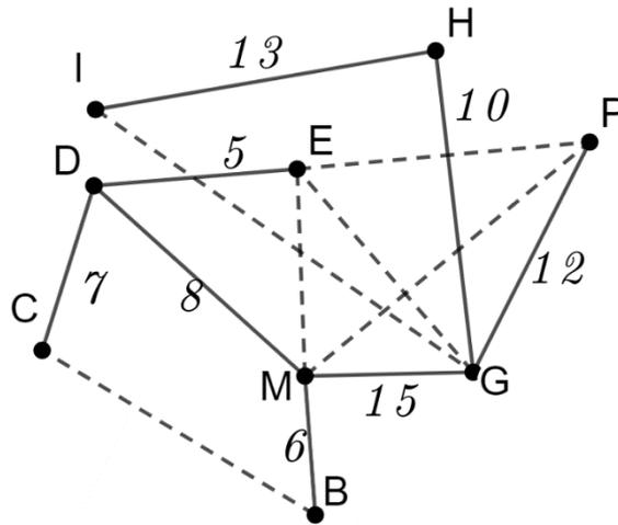
**Arbre couvrant de poids minimum obtenu par l'algorithme de Prim.**
