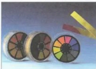
Fig. 9. Papier pH : à chaque couleur correspond une valeur de pH. Quel pH lisez-vous ?
