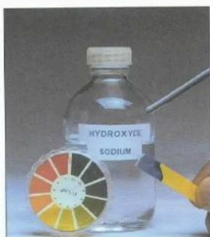
Fig. 5. Le papier pH bleuit (milieu basique) en présence d'une goutte de solution aqueuse d'hydroxyde de sodium
