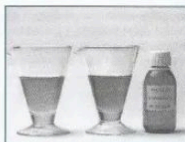
Fig. 8. Le bleu de bromothymol est vert dans l'eau (à gauche) et bleu dans une solution d'éthanoate de sodium à 10^{-2} \text{ mol.L}^{-1} (à droite) *
