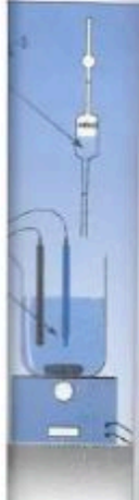
On ajoute la solution d'acide dans le bécher et on ajoute une solution de soude dans la burette.
