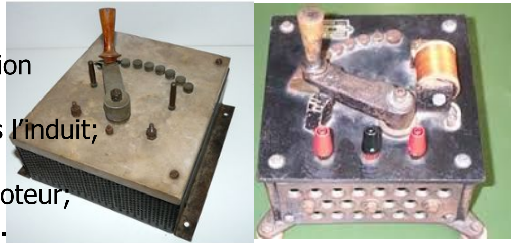
Rhéostat de démarrage
