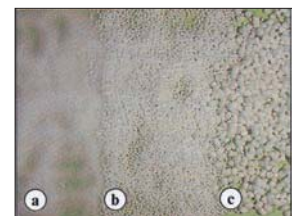
Polystyrène: (a) non expansé,(b) en cours d'expansion, (c) expansé
