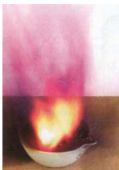
Réaction du diiode avec de l'aluminium
