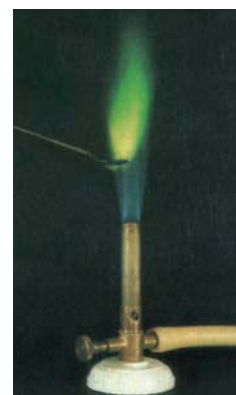
En présence de cuivre, une coloration verte apparaît à travers la flamme du bec Bunsen.
