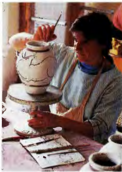
Peinture d'un vase en céramique avant l'application de la glaçure.
