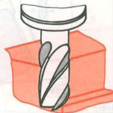
FRAISAGE EN AVALANT \vec{v}_a et \vec{v}_c de même sens
