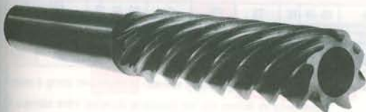
Fraise hélice à gauche, coupe à droite
