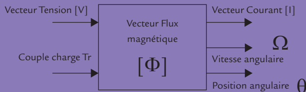
Figure 1.1 Principe de la conversion électromécanique
