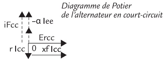
Figure 28.2 Détermination des coefficients du diagramme de Potier de l'alternateur ou du moteur synchrone à pôles lisses (régime saturé)
