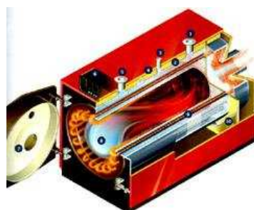
Figure. 4. Vue montrant le foyer de la chaudière à eau chaude à foyer borgne
