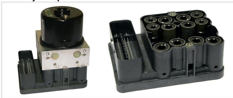
Figure 76. Le bloc contrôle dynamique de conduite.
