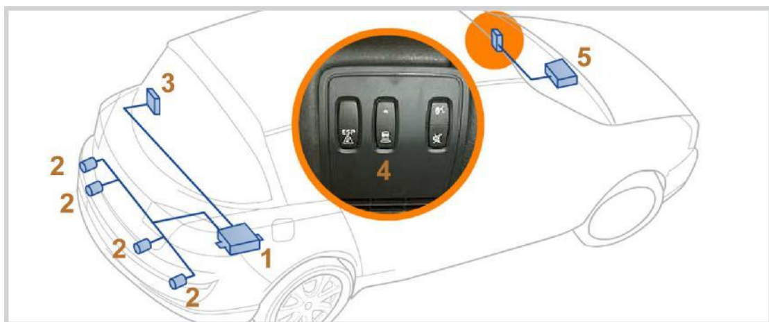
Figure 5. Les éléments du système d'aide au parking.
