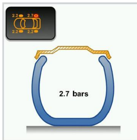
Figure 60. Le pneumatique est sur gonflé.
