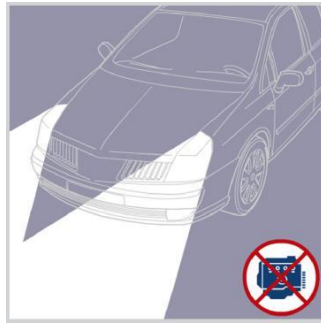
Figure 30. Le fonctionnement de l'éclairage d'accompagnement
