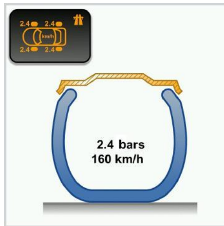
Figure 63. La pression du pneumatique est inadaptée à la vitesse du véhicule.
