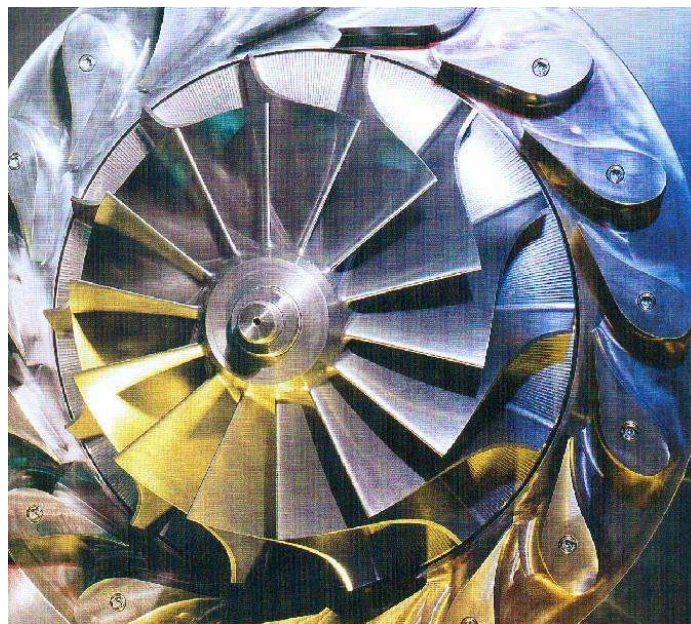
Figure II-3 Exemple de turbocompresseur centrifuge avec diffuseur à aubes orientables
