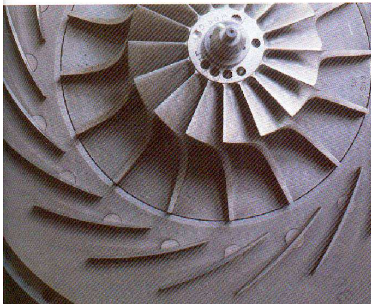
Figure II-11 Aubes orientables à la sortie d'un étage centrifuge
