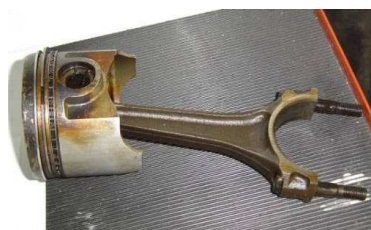
Bielle – piston Diamètre 10 cm Course 10 cm
