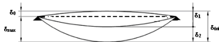
Figure 4. Déformations verticales d'une poutre bi-appuyée.
