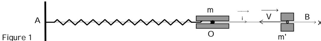
Le palet dans sa position d'équilibre est heurté par un autre de masse  $m' = \frac{1}{2} m$  animé d'une vitesse  $\vec{V}$  telle que  $\vec{V} = -V \vec{i}$ . Après le choc les deux palets restent accolés.
