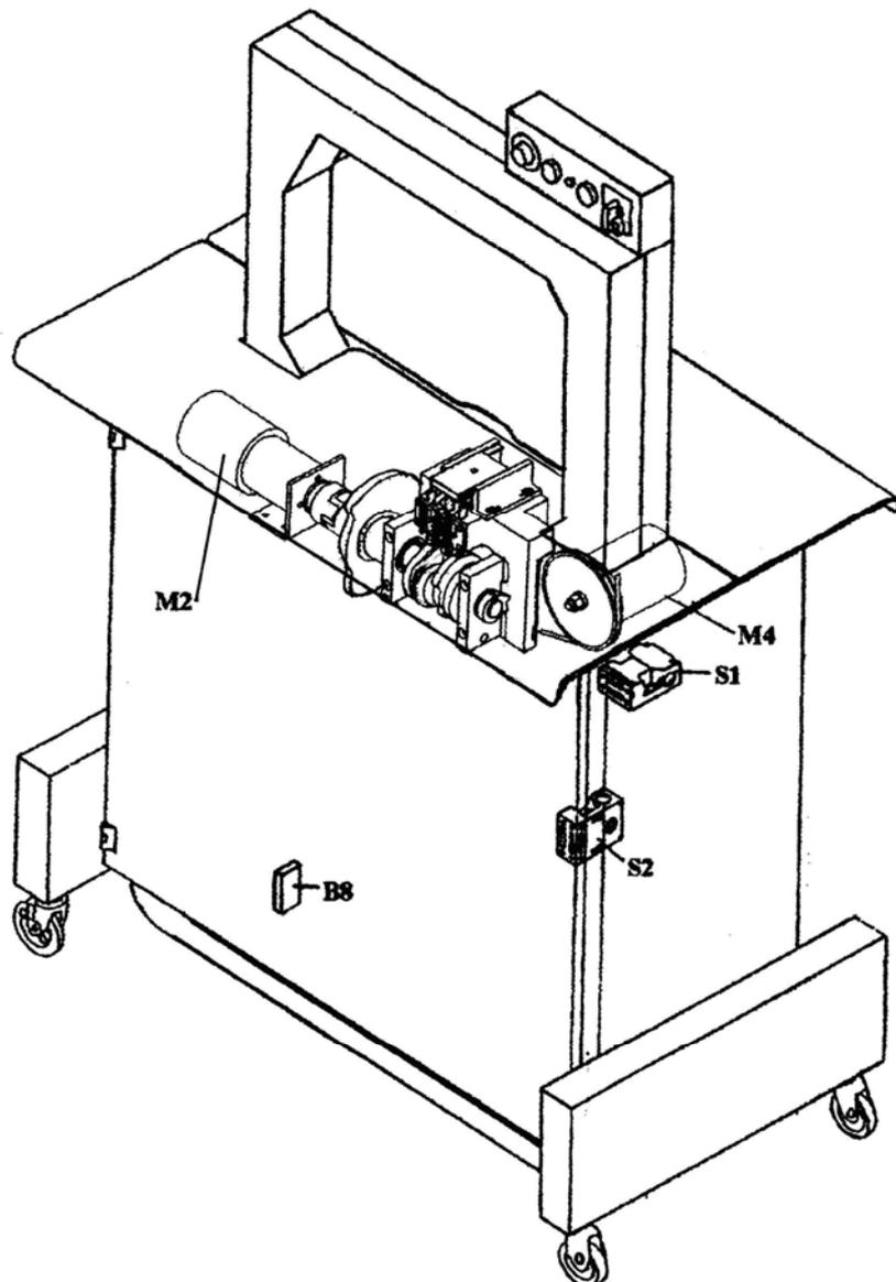
L'arche sert de guide au feuillard. Le feuillard pénètre à l'intérieur de ce guide par simple poussée du moteur M4 («moteur feuillard»). Cette arche, composée d'une partie fixe et d'un guide mobile, peut s'ouvrir libérant ainsi le feuillard qui peut encercler le colis.
