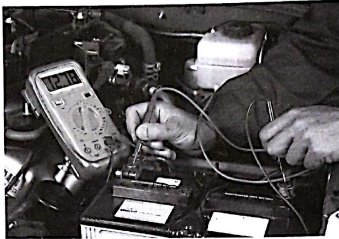
1. Le garagiste utilise un multimètre en fonction voltmètre.
