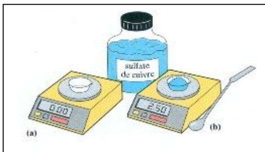
Doc. 1 : peser précisément  $m$  en prélevant le solide avec une spatule propre et sèche (b), et en le plaçant dans une capsule ou un verre de montre préalablement pesé (a).
