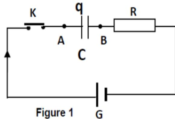
Le circuit est schématisé ci-contre (figure1). L'interrupteur K est fermé à la date  $t=0$ . Le sens d'orientation choisi est indiqué sur le schéma et  $q$  désigne la charge de l'armature liée à A.
