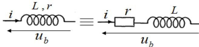
**Remarque :** Dans une bobine, l'énergie est emmagasinée sous forme magnétique :  $W_{mgn} = \frac{1}{2} Li^2$
