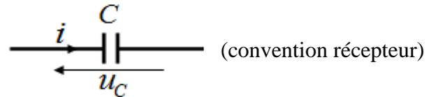
**Remarque :-** Dans un condensateur, l'énergie est emmagasinée sous forme électrique :  $W_{el} = \frac{1}{2} Cu_c^2 = \frac{1}{2} \frac{q^2}{C}$
