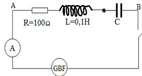
1. Rappeler l'expression générale de l'impédance d'un dipôle AB comprenant : un résistor, une bobine et un condensateur montés en série.
