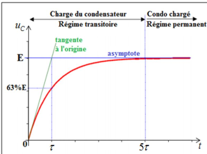
**Constante de temps  $\tau$**  : durée au bout de laquelle la tension aux bornes du condensateur en charge a atteint 63% de sa valeur maximale.
