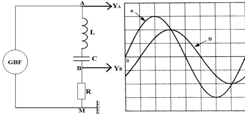
5. A l'aide de la construction de Fresnel, déterminer la relation donnant  $\tan \varphi$  en fonction des paramètres du circuit. En déduire la valeur de la capacité C du condensateur.
