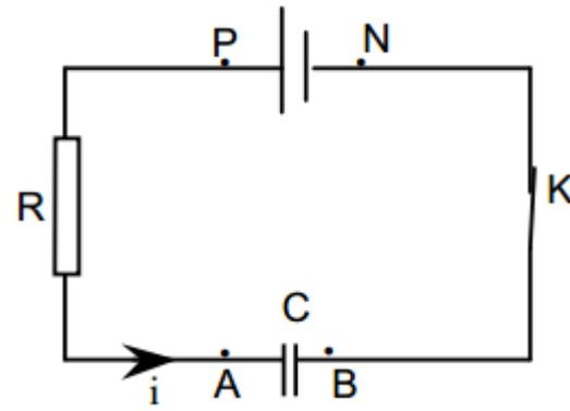
A la date  $t=0s$ , le condensateur étant chargé, on ferme l'interrupteur  $K$ , l'intensité instantanée  $i$  du courant est comptée positivement dans le sens qui pointe vers l'armature  $A$ (voir figure)
