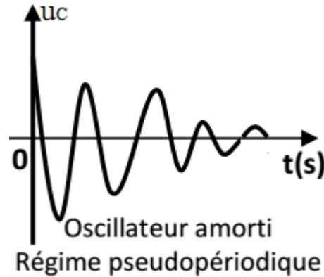
il en découle que la présence de la résistance dissipe l'énergie par effet Joule, l'amplitude des oscillations diminue au cours du temps : ce sont les oscillations pseudopériodique. Le circuit RLC libre est un oscillateur amorti car il est siège des oscillations sinusoïdales amorties.
