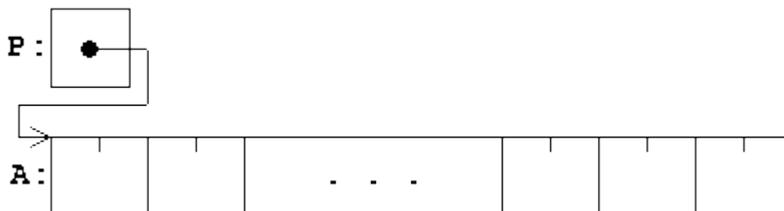
Si P pointe sur une composante quelconque d'un tableau, alors P+1 pointe sur la composante suivante. Plus généralement,
