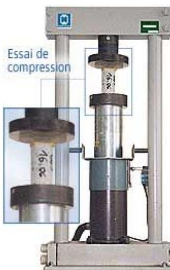
*Essais et contrôle sur les bétons frais*
