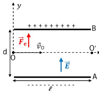
$$\vec{v} = \vec{a} t + \vec{v}_0 \text{ et } \vec{OG} = \frac{1}{2} \vec{a} t^2 + \vec{v}_0 t + \vec{OG}_0$$
