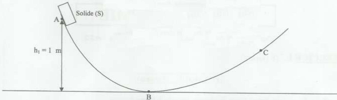
Le solide (S) de masse 1 kg effectue le trajet (AC) passant par le point B. Il part du point A sans vitesse initiale. Les frottements sont négligés et  $g = 10 \text{ N/kg}$ .
