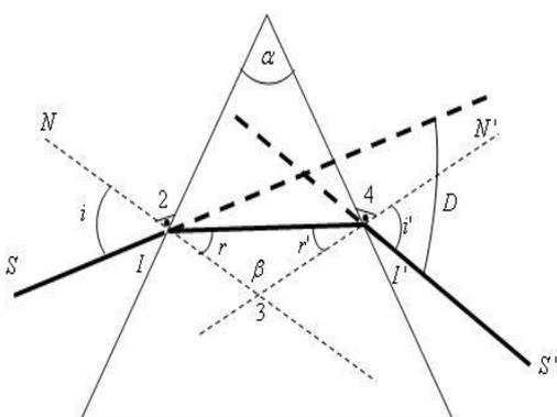
Le prisme utilisé est caractérisé par un indice  $n$  qui dépend de la longueur d'onde. Sa section est un triangle d'angle  $\alpha$ . Le prisme est placé dans l'air dont l'indice sera pris égal à 1. Un rayon rencontre une face au point I sous l'angle d'incidence  $i$  et ressort par l'autre face au point I' sous l'angle  $i'$ .
