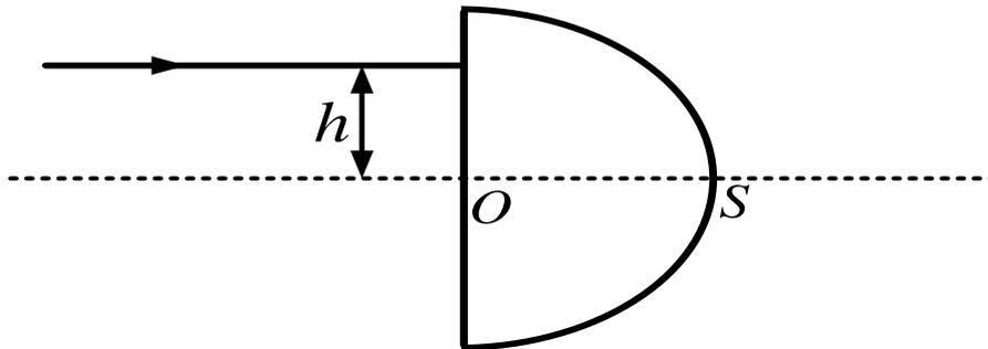
1. Un rayon quelconque à la hauteur  $h$  coupe l'axe de symétrie en un point  $F$  après réfraction à travers le dioptre sphérique. Faire un schéma clair du trajet suivi par le rayon jusqu'au point  $F$ , on y fera notamment figurer les angles d'incidence  $i$  et de réfraction  $r$  à travers le dioptre sphérique.
