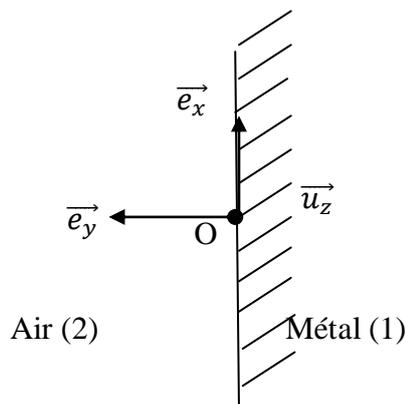
On envoie une O.P.P.M incidente de pulsation  $\omega$  et de polarisation rectiligne notée  $(\vec{E}_i, \vec{B}_i)$  sur cette plaque métallique, le vecteur d'onde de l'onde incidente étant  $\vec{k}_i = -k \vec{e}_y$  ( $k > 0$ ).
