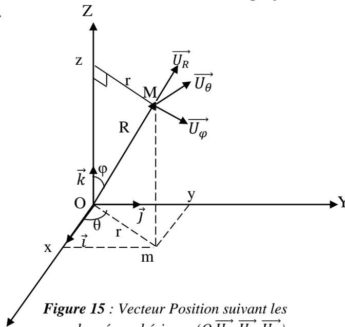
Figure 15 : Vecteur Position suivant les coordonnées sphériques  $(O, \overline{U}_R, \overline{U}_\theta, \overline{U}_\varphi)$
