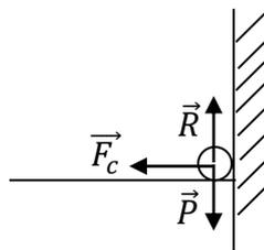
La balle change de direction à cause de la force de contact de la balle avec le mur  $\vec{F}_c$
