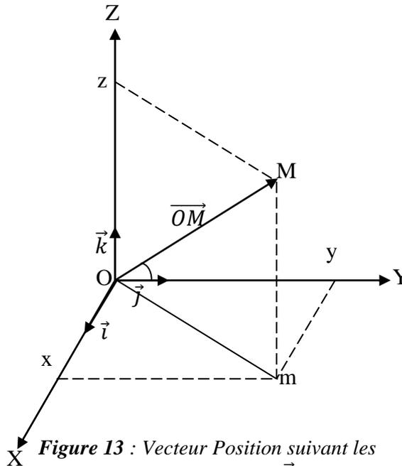
Figure 13 : Vecteur Position suivant les coordonnées  $(O, \vec{i}, \vec{j}, \vec{k})$
