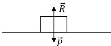
La force de réaction  $\vec{R}$  est l'action du support sur lequel repose le système et qui l'empêche de s'enfoncer vers le bas sous l'action de son poids.
