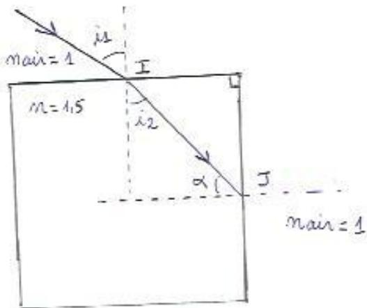
La lumière émerge en  $K$  si  $\alpha < \alpha_c$ ;  $\alpha_c$  est l'angle critique déterminé par  $\sin \alpha_c = \frac{1}{n}$ . AN:  $\alpha_c = 41,8^\circ$
