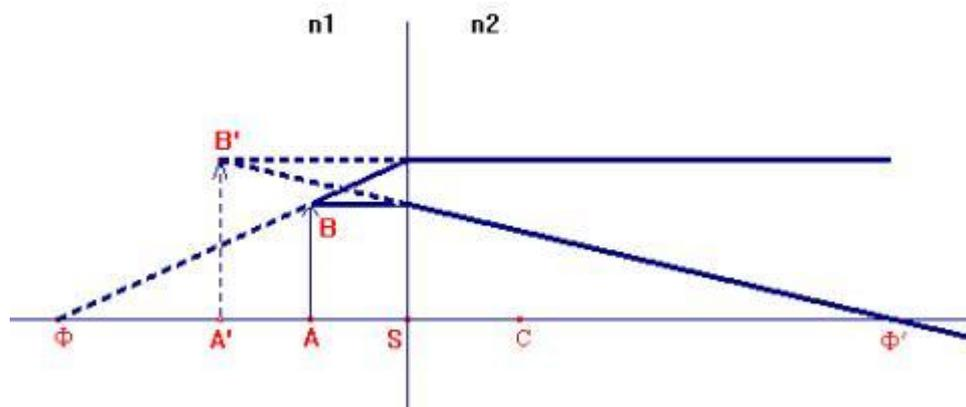
4) On retrouve la « formule » des lentilles minces. L'étudiant vérifiera que  $\frac{1}{\overline{S\Phi'}} = (n-1) \left( \frac{1}{\overline{SC_1}} - \frac{1}{\overline{SC_2}} \right)$  est donné par  $\frac{1}{\overline{S\Phi'}} = (n-1) \left( \frac{1}{\overline{SC_1}} - \frac{1}{\overline{SC_2}} \right)$  alors même qu'il n'y a évidemment plus de dioptre équivalent puisque  $n_2=n_1$  et  $\overline{SC} = 0$
