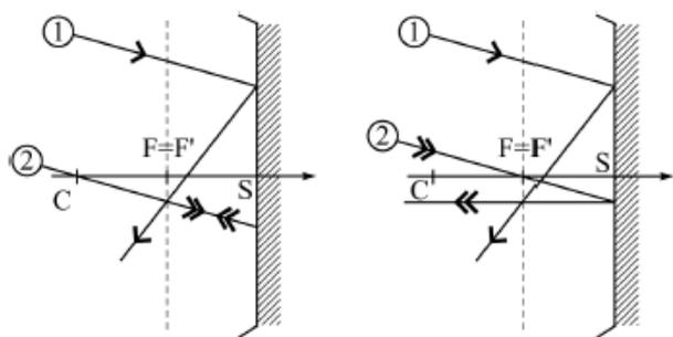
2) On trace un rayon ② incident venu de  $C$  et passant par l'intersection de ① avec le plan focal objet. Cette intersection peut être considérée comme un foyer objet secondaire dont l'image est à l'infini. Les rayons émergents doivent donc être parallèles entre eux. Le rayon passant par  $C$  n'étant pas dévié, il indique la direction du rayon ① émergent.
