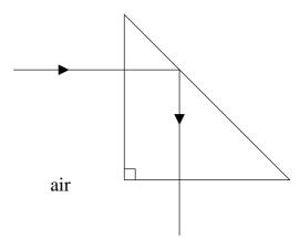
A quelle relation doit satisfaire l'indice n d'un prisme isocèle rectangle utilisé dans les conditions de la figure pour que l'on se trouve dans le cas d'une réflexion totale ?
