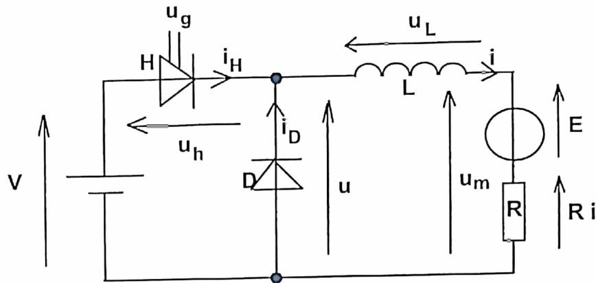
La tension  $u_g$  commande l'interrupteur électronique H. C'est une tension en créneaux représentée sur le document-réponse.
