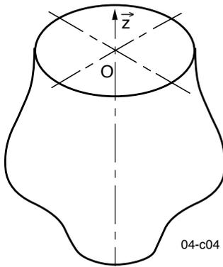
Un solide à symétrie matérielle de révolution possède nécessairement deux plans de symétrie matérielle perpendiculaires qui se coupent sur l'axe de révolution. Les éléments non diagonaux sont donc nuls pour tout repère centré sur l'axe de révolution admettant le vecteur directeur de cet axe comme vecteur de base.
