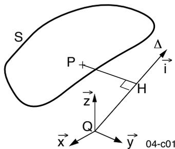
On considère un repère  $R\{Q, \vec{x}, \vec{y}, \vec{z}\}$ , un solide S et un axe  $\Delta$  défini par le point Q et le vecteur unitaire  $\vec{i}: \Delta = (Q, \vec{i})$
