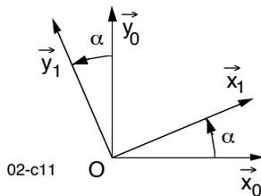
Il est nécessaire d'établir, à ce stade, des schémas de passage d'un repère à l'autre. Ces schémas feront apparaître les angles **petits (inférieurs à 30°) et positifs**. De cette façon, on ne peut se tromper sur les signes. De plus, le cosinus est plus grand que le sinus.
