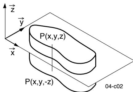
Si le solide S admet un plan de symétrie matérielle, l'expression de l'opérateur d'inertie dans un repère dont deux axes sont dans ce plan, a deux produits d'inertie nuls.
