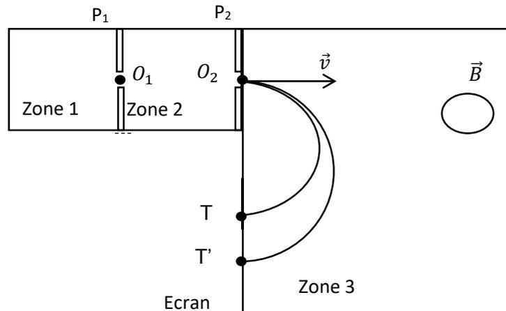
Un échantillon de potassium naturel est vaporisé puis ionisé dans la zone 1. Les ions créés quittent  $O_1$  sans vitesse initiale et entrent dans la zone 2 où ils sont accélérés grâce à un champ électrostatique  $\vec{E}$  créé par une différence de potentiel  $U_0 = V_{P_2} - V_{P_1}$  (l'armature  $P_1$  passe par  $O_1$  et l'armature  $P_2$  passe par  $O_2$ ).
