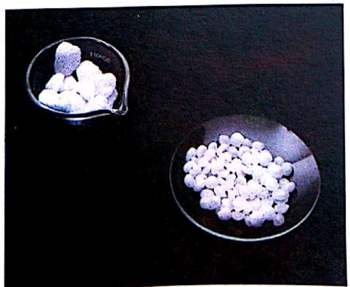
5. A gauche, cristaux d'hydroxyde de potassium (potasse). A droite, cristaux d'hydroxyde de sodium (soude).
