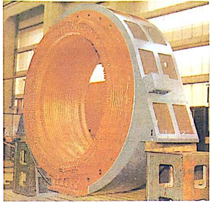
9. Alternateur destiné à une centrale E.D.F. A gauche la partie tournante (ou rotor), à droite la partie fixe (ou stator).
