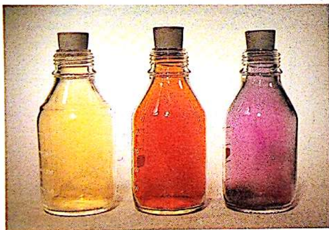
7. A l'état gazeux, les corps simples Cl_2 , Br_2 et I_2 sont faciles à reconnaître : Cl_2 est vert-jaune, Br_2 rouge et I_2 violet.
