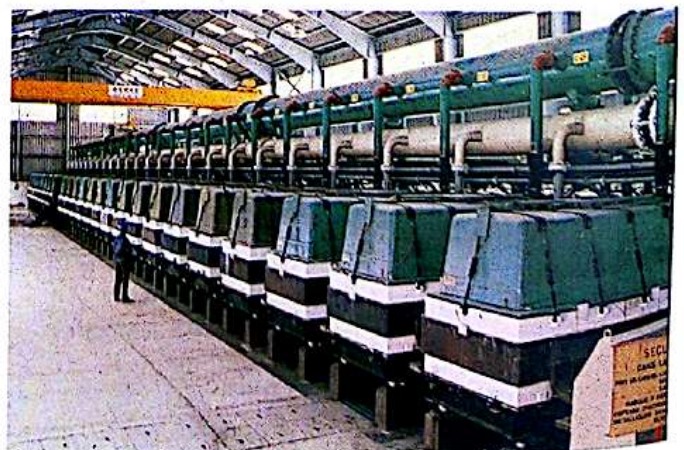
8. Électrolyse industrielle du chlorure de sodium.
