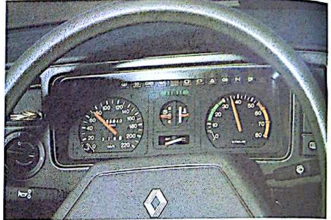
3. Le tachymètre indique la vitesse instantanée de l'automobile : 72 \text{ km} \cdot \text{h}^{-1} .
