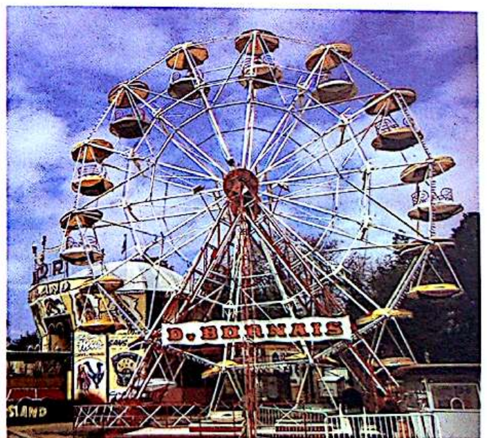
13. La grande roue est animée d'un mouvement de rotation autour de son axe, fixe. Les nacelles sont pratiquement animées d'un mouvement de translation circulaire.
