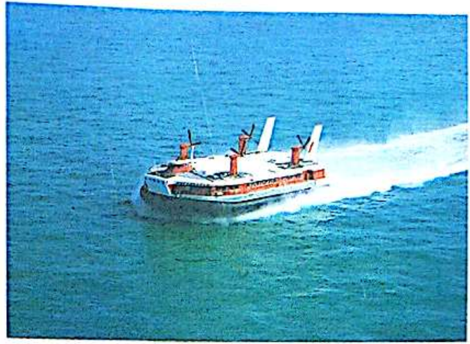
5. Malgré la mise en mouvement, la réaction du coussin d'air sur l'overcraft reste perpendiculaire à la surface de contact, et par la-même compense l'effet du poids de l'engin.
