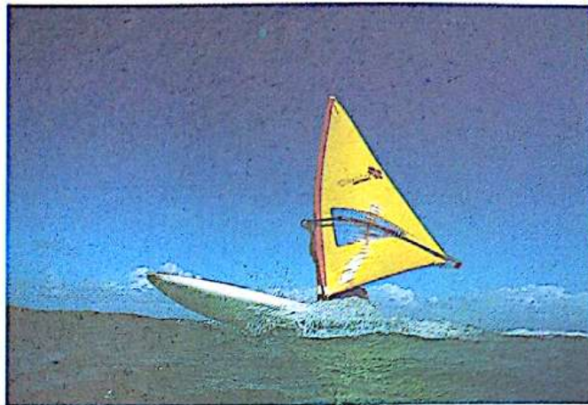
3. Le vent exerce des actions de contact réparties en surface sur la voile. L'eau exerce également des actions de contact réparties sur la planche.
