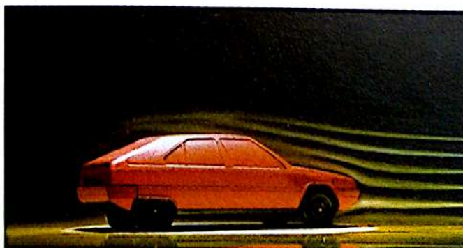
5. L'écoulement de l'air autour d'une carrosserie est mis en évidence, dans une soufflerie, par des filets de fumée.
