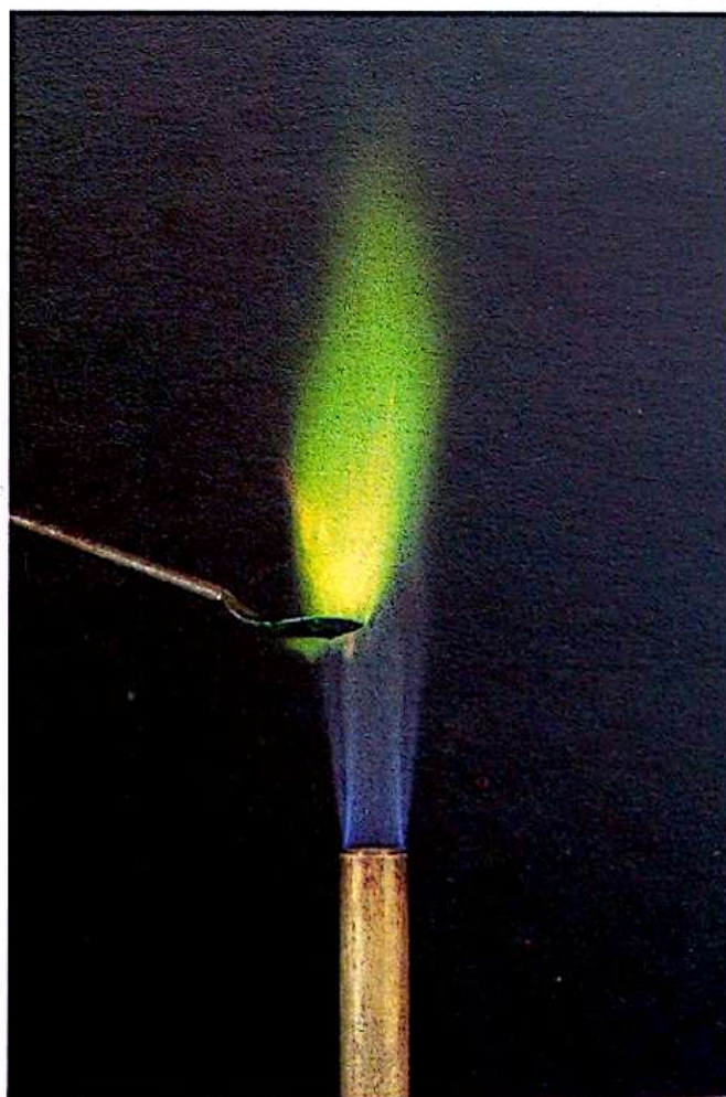
6. Mise en évidence de l'élément cuivre (test à la flamme).
