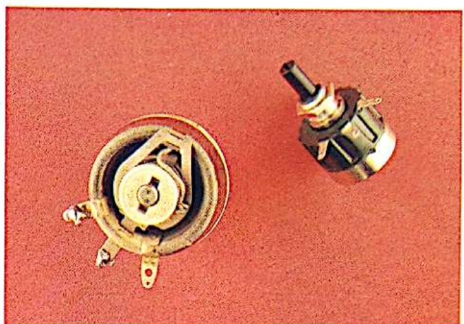
4. Rhéostats de type radio et leur représentation symbolique.
