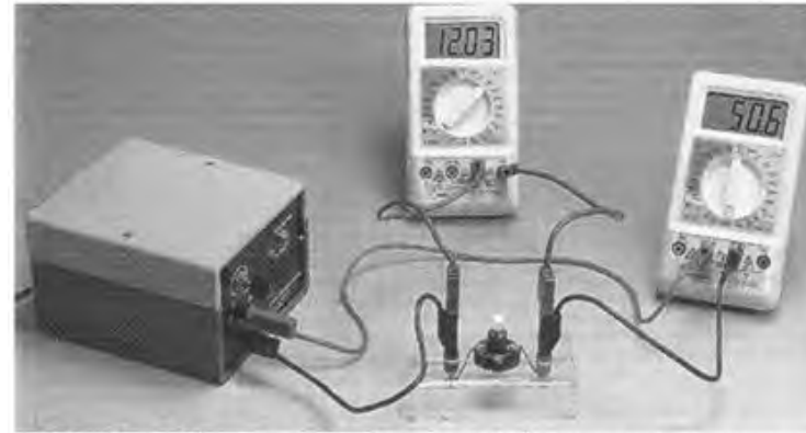
Montage de variation d'intensité de courant traversant une lampe électrique de 12V-21 W
