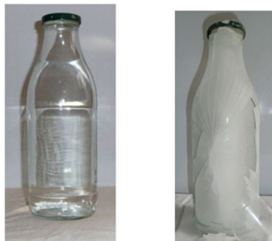
Document 4 : Augmentation du volume au cours de la solidification de l'eau
