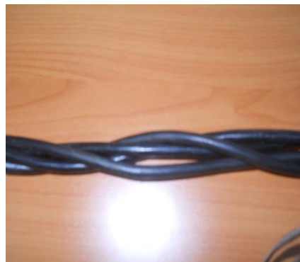
Câble de branchement triphasé (4x16 2 )
